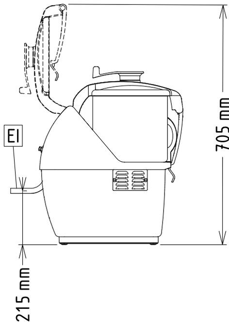
EI = Conexión eléctrica (energía)
